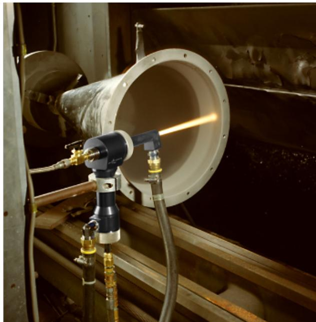
等离子堆焊技术在煤矿机械行业应用：截齿：截齿是采掘设备中大量使用的易损件，在截齿本体靠近硬质合金头部位堆焊耐磨带，是提高使用寿命的有效措施。采用粉末等离子堆焊技术强化截齿耐磨带是提高截齿寿命的较佳工艺。截齿等离子堆焊机采用一体式结构，将整个等离子堆焊工艺高度集成在控制系统中，完全实现傻瓜化操作，生产效率高。螺杆、钻杆等易损件的修复：在矿井运行设备中，各种螺杆、钻杆、轴、链轮、减速机、泵、风机等运转机械中的工作面，会因磨损、腐蚀而造成配合尺寸超差或表面失效。采用等离子堆焊表面强化修复手段进行再制造，可节省开支，缩短维修周期，发挥已有资源的潜力。江苏微束等离子堆焊系统等离子堆焊技术几乎遍及所有的制造业。
