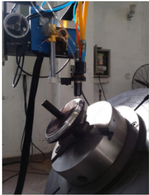
粉末等离子堆焊工艺已应用于工业制造业的多个领域,主要目的在于获得有特定性能(耐磨、耐蚀、耐温等性能)的合金硬面层。从应用角度有以下分类:按工件堆焊面的几何形状分类。主要分为:园平面、园锥面、园柱面、园柱螺旋面、平面线段或平面等。针对不同类型的工件,在工艺控制程序上有所区别。对于复杂的平面线段(连续或不连续的直线段或曲线段),要实现全自动堆焊,就要采用数控系统。对同一类型工件,在几何尺寸上相差甚大者,则要选择相适应的机型。按工件所属的制造行业分类。根据目前的应用情况,主要有:阀门制造行业、气门制造行业、冶金轧制工具制造行业、石油机械行业、煤矿机械行业、电力机械行业等等。随着应用范围的扩大,将会有更多的制造行业在产品的修造中采用粉末等离子堆焊技术。
