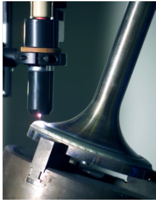
等离子堆焊是以等离子弧作为热源，应用等离子弧产生的高温，由送粉器向焊枪供粉，等离子弧将合金粉末与基体表面迅速加热并一起熔化、混合、扩散、随焊枪和工件的相对移动，等离子弧离开后自激冷却，液态合金逐渐凝固，形成一层高性能的合金层，从而实现零件表面的强化与硬化的堆焊工艺，由于等离子弧具有电弧温度高、能量集中、稳定性好、稀释率低、熔深可控性强。等离子粉末堆焊后基体材料和堆焊材料之间形成融合界面，结合强度高，堆焊层组织致密；利用粉末作为堆焊材料可提高合金设计的选择性，特别是能够顺利堆焊难熔材料，提高工件的耐磨、耐高温、耐腐蚀性和耐冲击性。采用等离子堆焊的方法在柱塞表面堆焊耐磨合金，具有运行成本低的优点。江苏微束等离子堆焊系统
